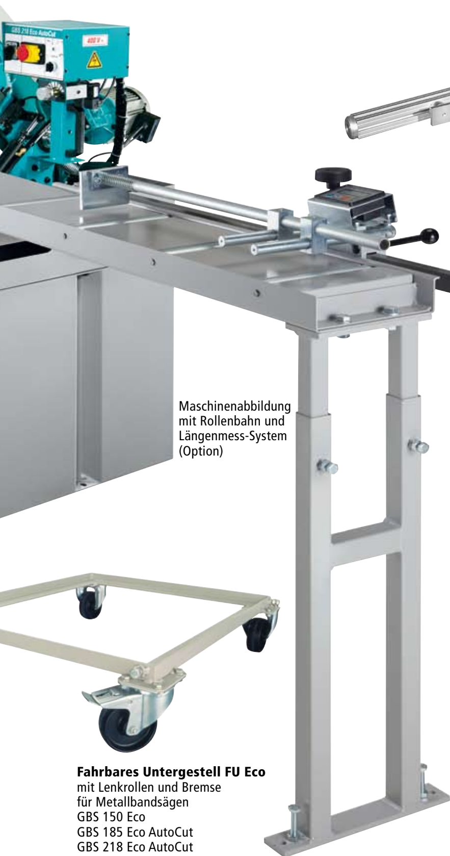
Digitales Längenmess-System EasyMess XL Modernste Längenmesstechnik universell einsetzbar. Digitale Positionsanzeige. Maßabnahme über Magnetband und Sensor. Messgenauigkeit \pm 0,1 mm/m Zählrichtung frei wählbar
